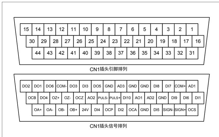
转矩模式接线图 (适用于模拟量输入控制)
